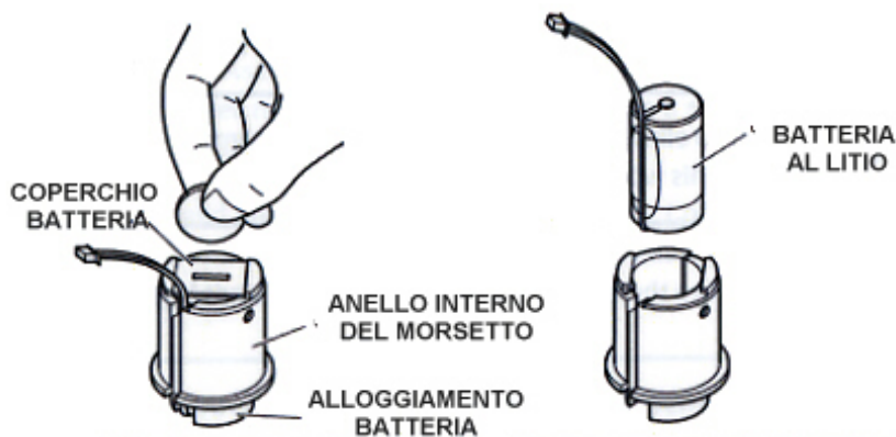
Fig. 23 RIMOZIONE COPERCHIO BATTERIA
